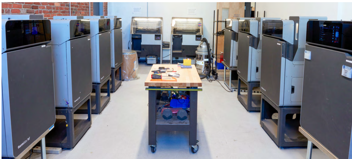
Formlabs' Materiallabor für F&E im Bereich SLS in Somerville ist etwa 37 m 2 (180 m 3 ) groß mit mehr als zehn Druckern der Fuse-Serie und vier Fuse Sifts.
